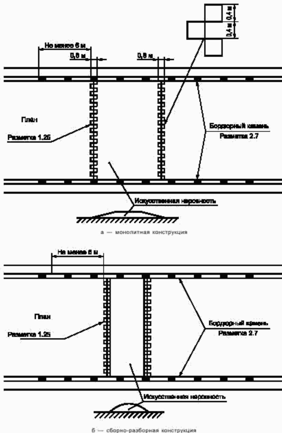
Рисунок 4 — Пример нанесения разметки 1.25 и 2.7 при устройстве ИН
